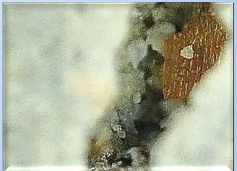
▲ 接着界面から内部に針状結晶が生成し、モルタルを緻密化している。
